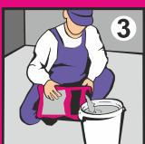
Для подготовки раствора залейте водопроводную воду комнатной температуры в чистую ёмкость из расчёта 5,5-6,5 л на 1 мешок (25 кг).
