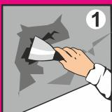
Подготовьте основание, удалите с него ослабляющие сцепление вещества: масляные и битумные пятна и прочие загрязнения. Отслаивающиеся участки удалите стальным шпателем. При оштукатуривании фасадов наружную гидроизоляцию и установку водоотводящих систем выполните до начала работ.
